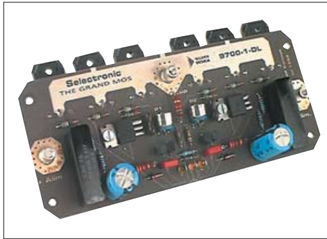
Carte amplificatrice (circuit TÉFLON argenté)
